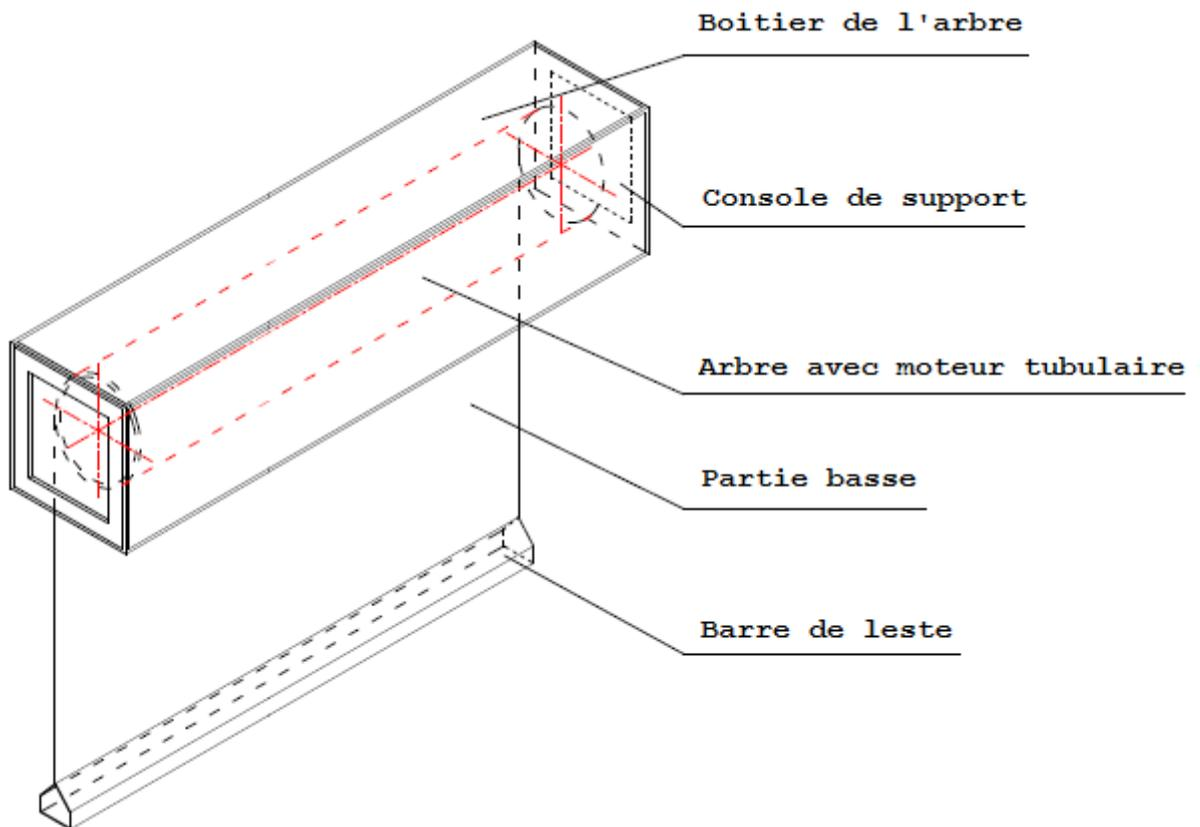
Vue en coupe et sélection du système de capotage et montage
